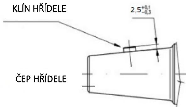
2. Odstraňte nečistoty (nánosy koroze, mastné substance), které se nacházejí na čepu hřídele, a umístěte stabilizační kolík do otvoru. Pro zjednodušení nastavte hřídel tak aby se technologický otvor pro kolík nacházel v horní poloze.
